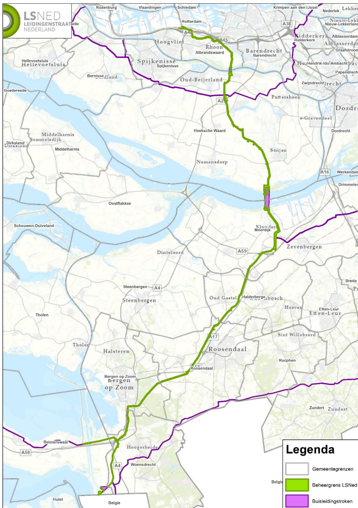
Figuur 1 – Het tracé van de Buisleidingenstraat en de aansluitende buisleidingstroken uit het Programma Energiehoofdstructuur (maart 2024)
